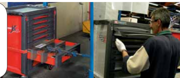
Los cajones se prueban para 50.000 aperturas/cierres o para 10 años e uso.
