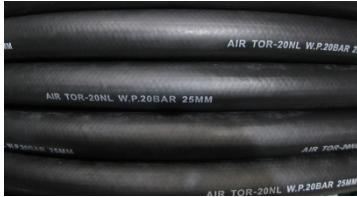
Tuyau extrudé avec intérieur et extérieur en caoutchouc spécial. Refoulement à 20 bar, éclatement à 60 bar. Température -20°C/+80°C. Norme ISO 1307. Eau, Air.
