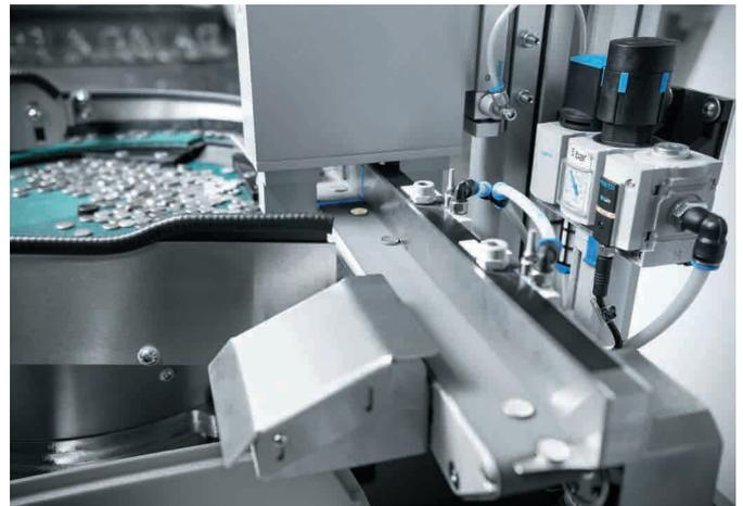
Checkbox CHB-C-N comprueba los discos metálicos y controla todo el proceso de clasificación. La inspección de calidad y de posición se lleva a cabo sin contacto
