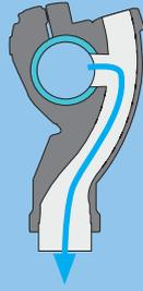
Las bridas de derivación "instalación rápida" de nueva generación, permiten realizar bajadas rígidas o flexibles, verticales o deportadas horizontalmente.
