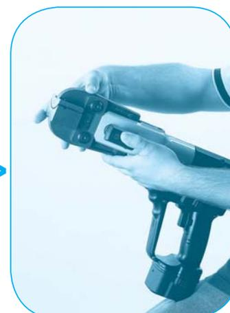
Bloquear la pinza volviendo a cerrar el eje de retención.
