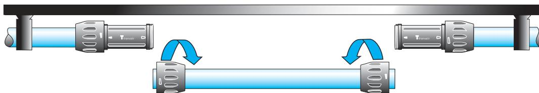
Desatornillar las tuercas situadas del lado del tubo que se va a desplazar, deslizarlas a lo largo del mismo. Después extraer el tubo.
