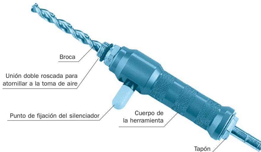
Utilizar la herramienta de perforación para instalar una brida para toma de aire bajo presión. La herramienta se adapta fácilmente a cualquier taladro estándar.
