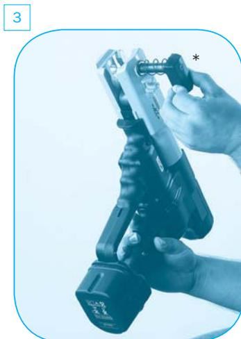
Abrir el eje de retención en la parte delantera de la máquina pulsando el botón \*
