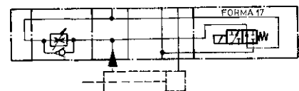
VARIANTE 1: Regulación por "A" en la entrada. Velocidad rápida. VERSION1: Fast meter out.
