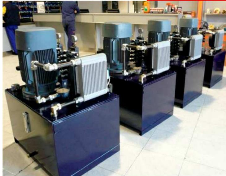
Roydisa diseña y fabrica 4 grupos hidráulicos para el accionamiento de la autocimbra del Viaducto O Eixo. Los equipos accionados con motor de 15 KW, *trabajan con una bomba de doble de 16+16 litros a una presión de 250 bar. La maniobra de la autocimbra es comandada por un conjunto de 16 electroválvulas Cetop3.*
