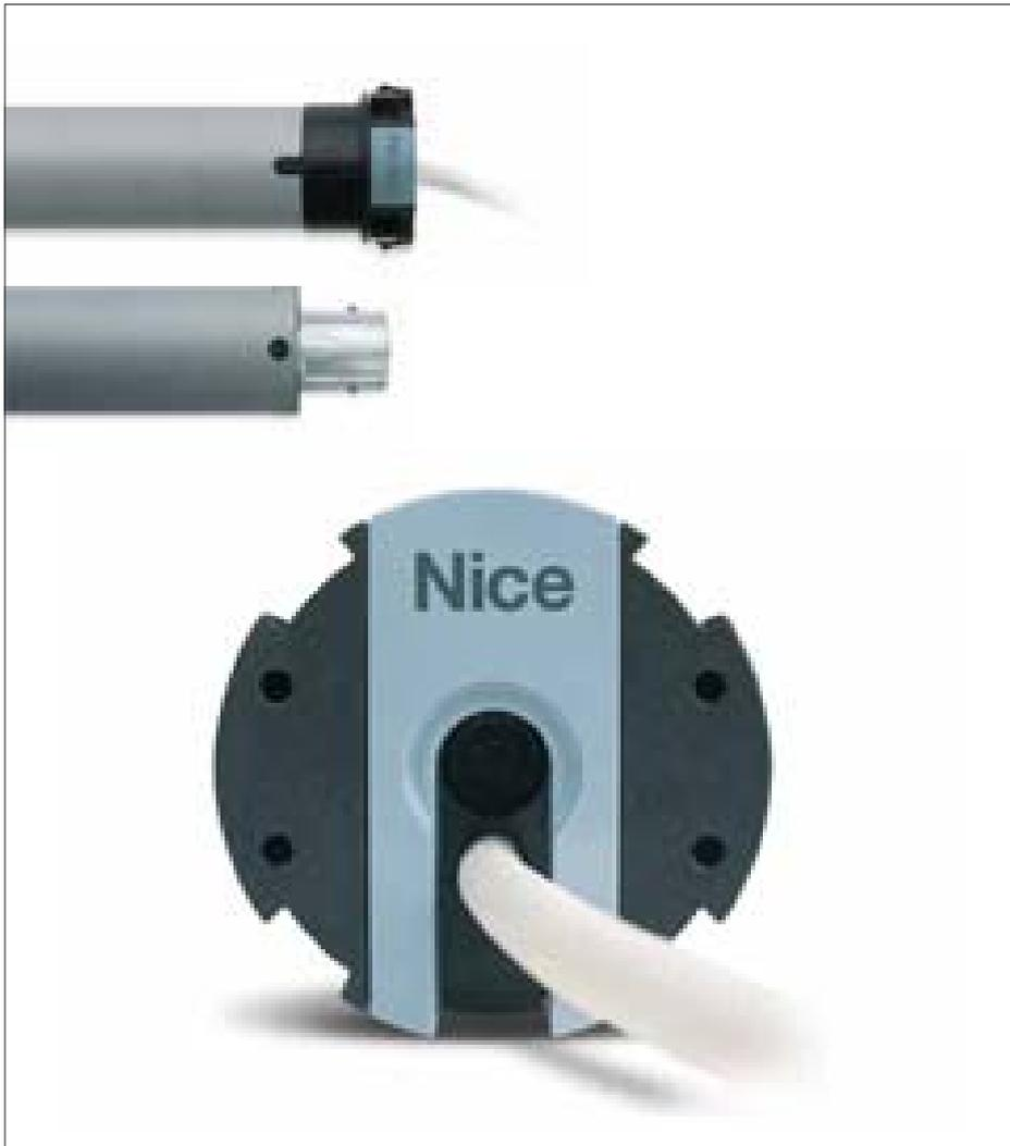
**Motor tubular ideal para cualquier tipo de toldo y cortina: toldos, cortinas de interiores y toldos para jardines de invierno. Con central de mando y receptor integrados, final de carrera electrónico y control del movimiento por encoder con tecnología TTBUS. Tamaño M Ø 45 mm.**
