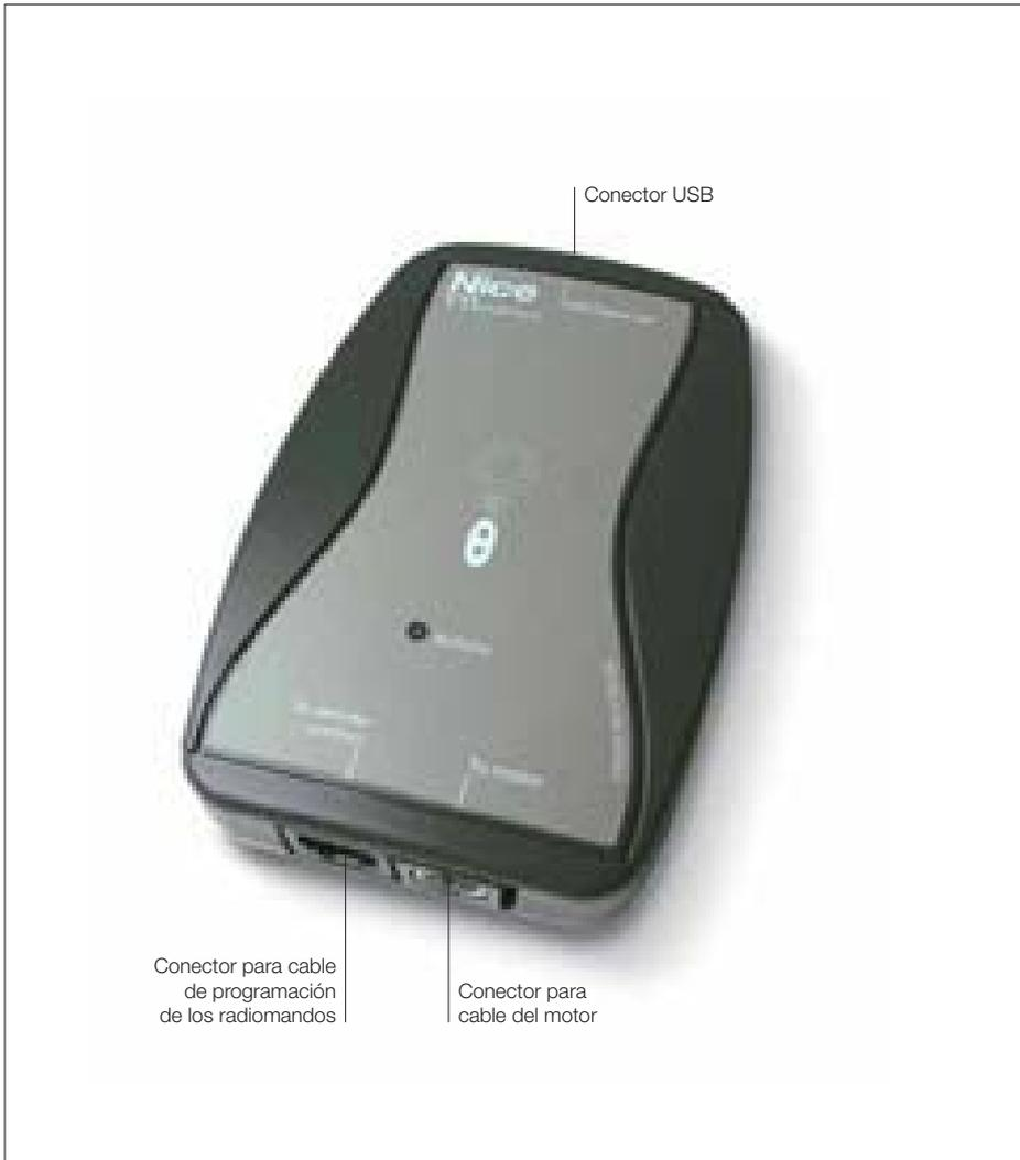
**Unidad de programación y software para centrales y motores preparados para la conexión TTBUS.**
