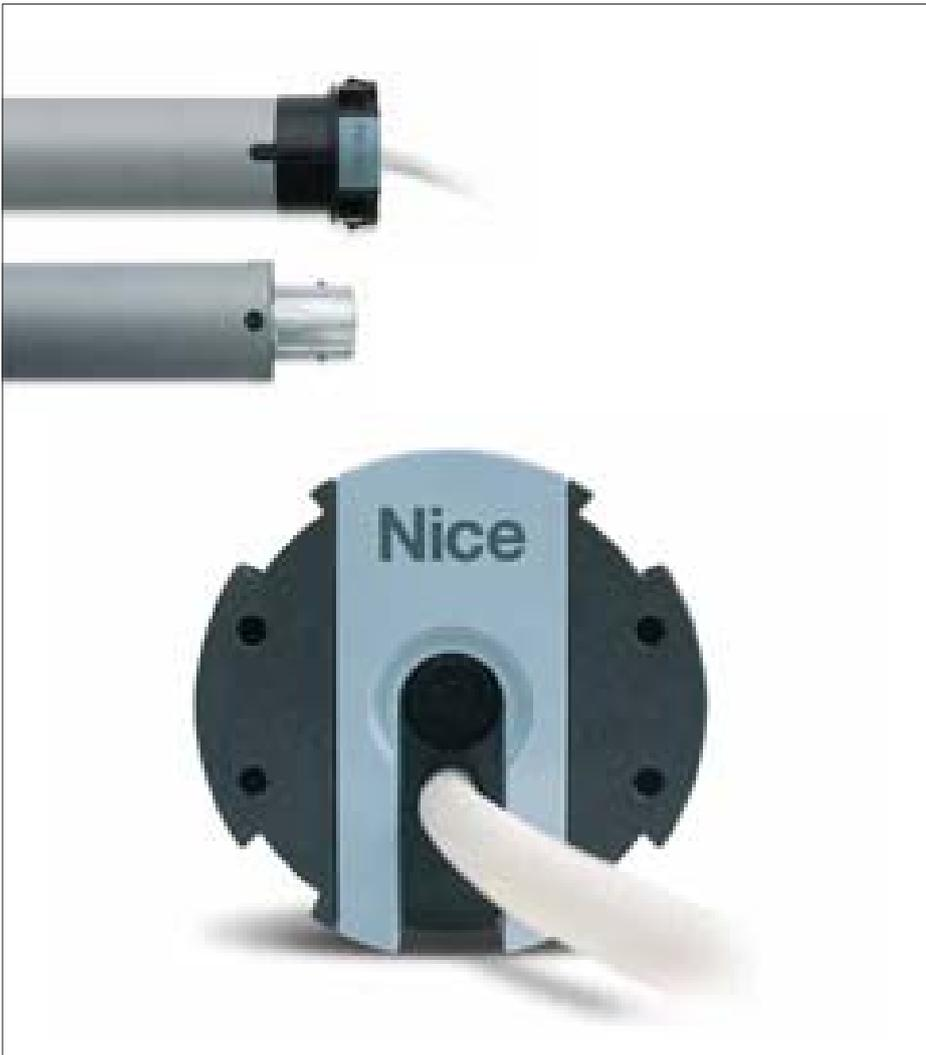
**Motor tubular ideal para persianas, incluso de medidas pequeñas, con central de mando y receptor integrados, fin de carrera electrónico y control del movimiento por encoder con tecnología TTBus. Tamaño M Ø 45 mm.**
