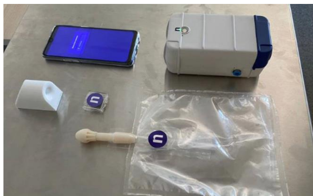
Figura 23. La toma de muestra se realiza a través de la espiración en la bolsa por una de las vías nasales. Luego la bolsa se conecta al dispositivo sensor y se realiza el análisis de VOCs presentes en la muestra para reportar los resultados en un dispositivo móvil.
