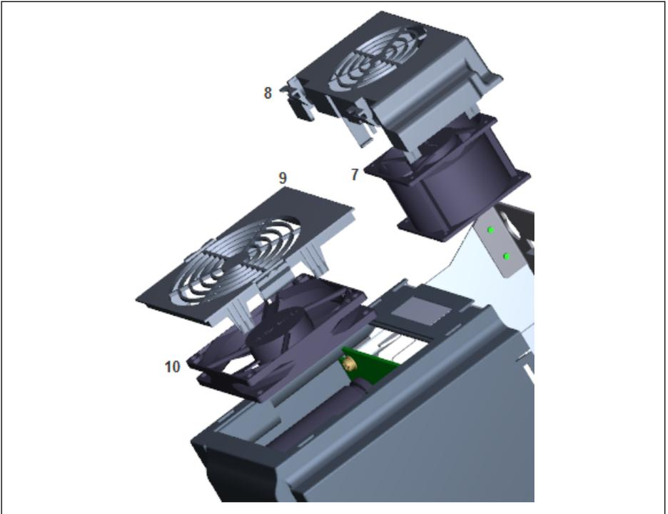
**Fig. 17-3:** Desmontar el ventilador
