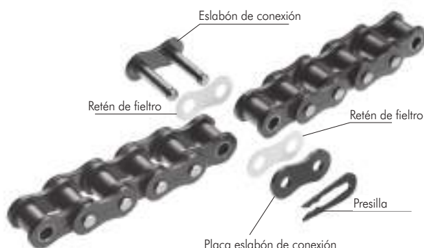
Fig. 12 Método de conexión de BS X-LAMBDA
