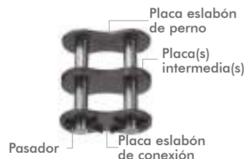
Eslabón de conexión con pasador de múltiples hileras (se muestra de 2 hileras)
