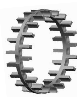
Fig. 5. Jaula de una pieza, tipo lengüeta.
