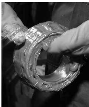
Fig. 15. La grasa se puede aplicar fácilmente con la mano.
