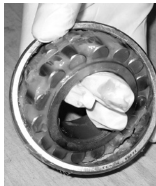
Fig. 21. La grasa se puede aplicar fácilmente con la mano.
