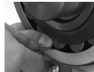
Fig. 15. Durante el montaje, el RIC debe controlarse en el rodillo sin carga.
