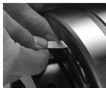
Fig. 18. Medida del RIC antes de la instalación.
