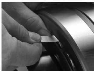
Fig. 14. Medida del RIC antes de la instalación.
